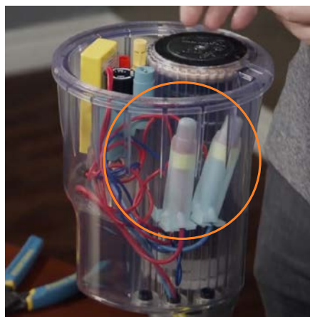
Figure 1 : Installez les connecteurs étanches en orientant le bas des capsules vers le haut.
