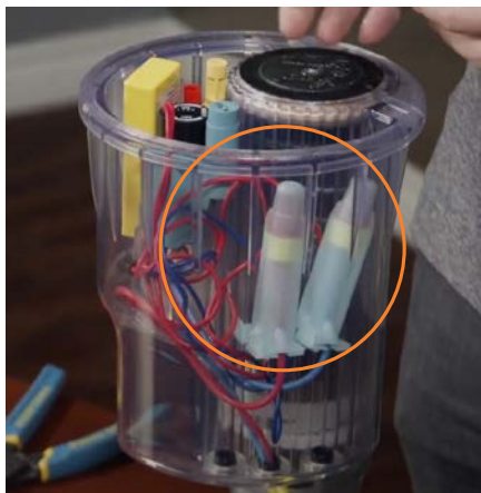
Figura 1: Instale los conectores resistentes al agua con la parte inferior de las cápsulas hacia arriba.
