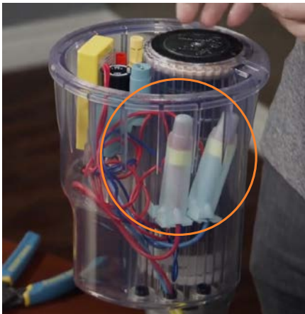
Abbildung 1: Installieren Sie die wasserdichten Verbinder so, dass die Unterseite der Patrone nach oben zeigt.
