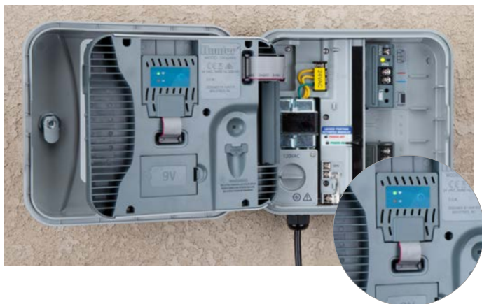
P2C-400 控制器，已连接 PC-WIFI 模块
