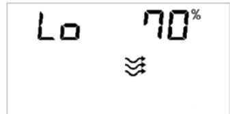
7. Pulse la flecha derecha para acceder a la **configuración de desbordamiento**. El umbral de desbordamiento supone una parada total en caso de de alto flujo y se puede establecer de 1 a 1000 GPM o l/min. Esta alarma se aplica a todas las estaciones y programas, cerrando todo el riego cuando se supera el umbral máximo.
