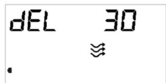
9. El último paso en la configuración de la monitorización del caudal es el **aprendizaje del caudal a nivel de estación**. Para acceder a los caudales nominales de cada estación del sistema, pulse la flecha derecha en el menú de retraso. Recorra todas las estaciones utilizando los botones de flecha izquierda y derecha para ver o introducir manualmente todas las tasas de caudal esperadas.
